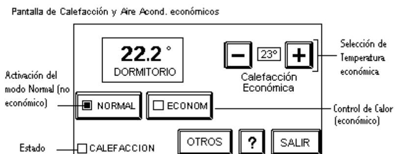
Pantalla Control de Climatización - Temperatura Económica
